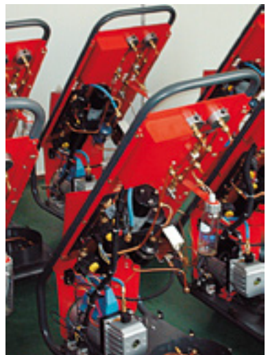
Rys. 8. Starsza konstrukcja urządzeń obsługowych oparta na miedzianych przewodach i zbiornikach.
