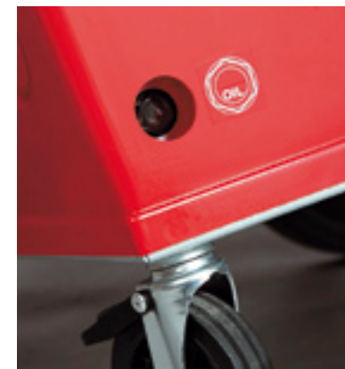
Rys. 6. Okno kontrolne oleju w pompie próżniowej, użytkownik w każdym momencie może ocenić ilość i jakość oleju.
