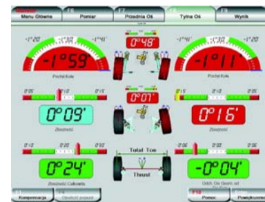
Rys. 11. Wyniki pomiaru dla osi tylnej.
