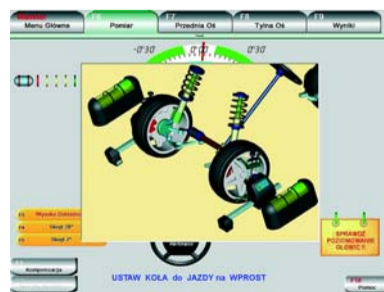
Rys. 10. Komunikat po wykryciu błędnej regulacji ustawienia głowic.
