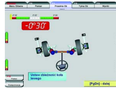
Rys. 13. Regulacja zbieżności przy kołach skręconych.
