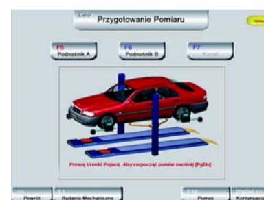
Rys. 14. Pomiar przy zwolnionych kołach.
