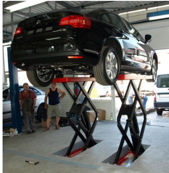
Fot.4. STRATOS S36 – podnośnik nożycowy, podprogowy o udźwigu 3600kg. Po złożeniu podnośnika możliwy jest przejazd samochodem we wszystkich kierunkach
