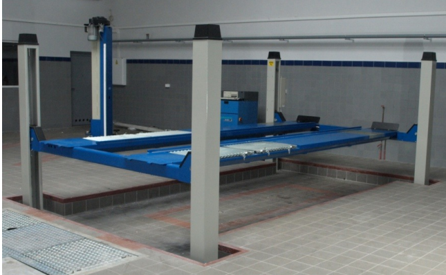
Fot.5. WERTHER 450AT – podnośnik czterokolumnowy, elektrohydrauliczny, samopoziomujący się o udźwigu 4500 kg i długości pomostów 4800 mm. Posiada płyty oscylacyjne oraz zagłębienia pod obrotnice przeznaczone do prowadzenia pomiarów i regulacji ustawienia geometrii kół
