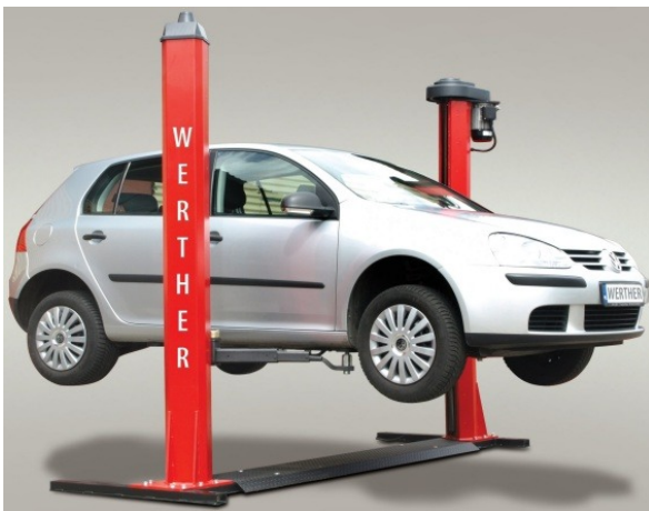
Fot.1. WERTHER 255 – podnośnik z podstawą o udźwigu 2500 kg najczęściej wybierany przez otwierających nowe warsztaty
