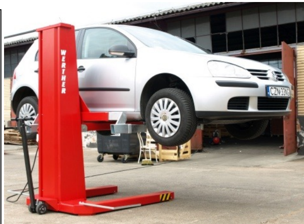
Fot.8. MM25 – uniwersalny podnośnik kolumnowy, mobilny – pozwala na pracę w dowolnym miejscu, transport samochodów, zakładanie i zdejmowanie na ramę blacharską, itd. Ta specjalna konstrukcja dorównuje sztywnością podnośnikom dwukolumnowym
