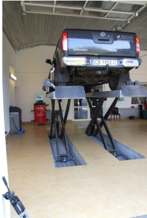
Fot.6. Saturnus 45 ATLTPG – podnośnik nożycowy, najazdowy o udźwigu 4500kg z dodatkowym wyposażeniem do prowadzenia pomiarów geometrii kół oraz kontroli luzów układu jezdnego i kierowniczego
