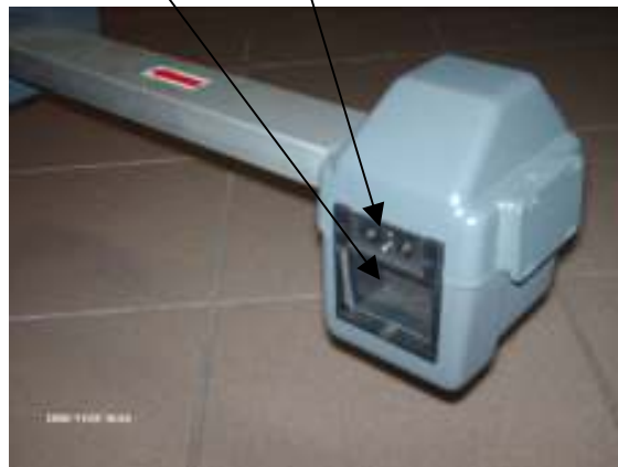
Rys. Para nadajnik-kamera pozwala na sprawdzenie wzajemnego położenia kąowego głowic w płaszczyźnie poziomej
