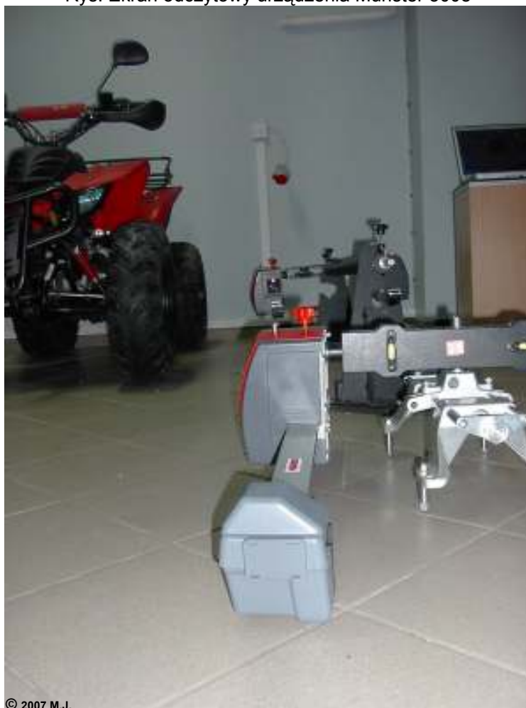
Rys. Parę głowic obracamy na osi uchwytu, druga para głowic nieruchoma – zmiany wskazań kątów poziomych par muszą być prawie identyczne
