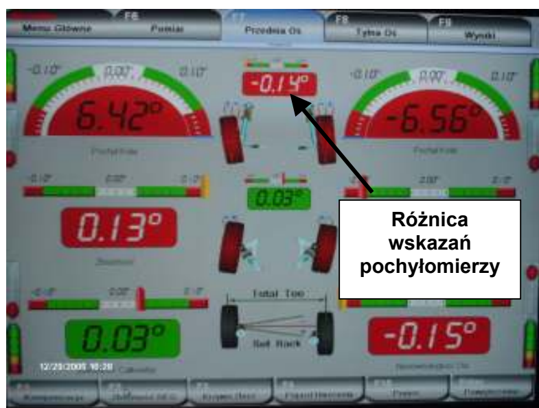
Rys. Ekran pomiarowy urządzenia Munster 3008
