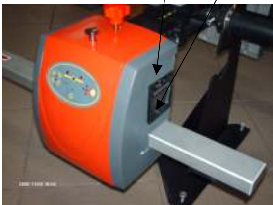
Rys. Para nadajnik-kamera pozwala na sprawdzenie wzajemnego położenia kąowego głowic w płaszczyźnie poziomej
