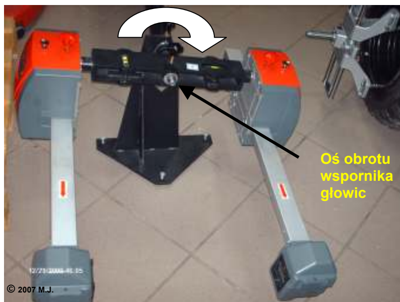
Rys. Sztywno połączone głowice winny wskazywać stałą różnicę kątów pochylenia
