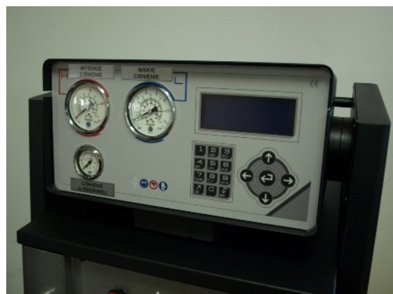
Fot. Panel czołowy urządzenia obsługowego; manometry dostosowane do R1234yf, oznakowane czynniki ryzyka, komputer wspomagający proces obsługowy [Werther Polska]
