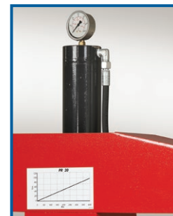
Manometr wraz z nomogramem pozwalają na odczyt i regulację nacisku
