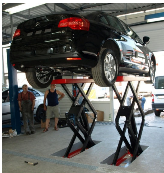
Fot.4. STRATOS S36 – podnośnik nożycowy, podprogowy o udźwigu 3600kg. Po złożeniu podnośnika możliwy jest przejazd samochodem we wszystkich kierunkach
