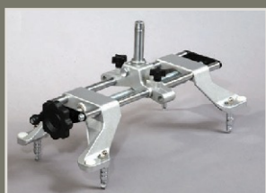
Uchwyt koła - 4 sztuki - pokrętło szybkiego mocowania - uniwersalne pazury do obręczy stalowych oraz ALU - łatwoobniżalna oś pomiarowa przydatna przy niskich spoilerach
